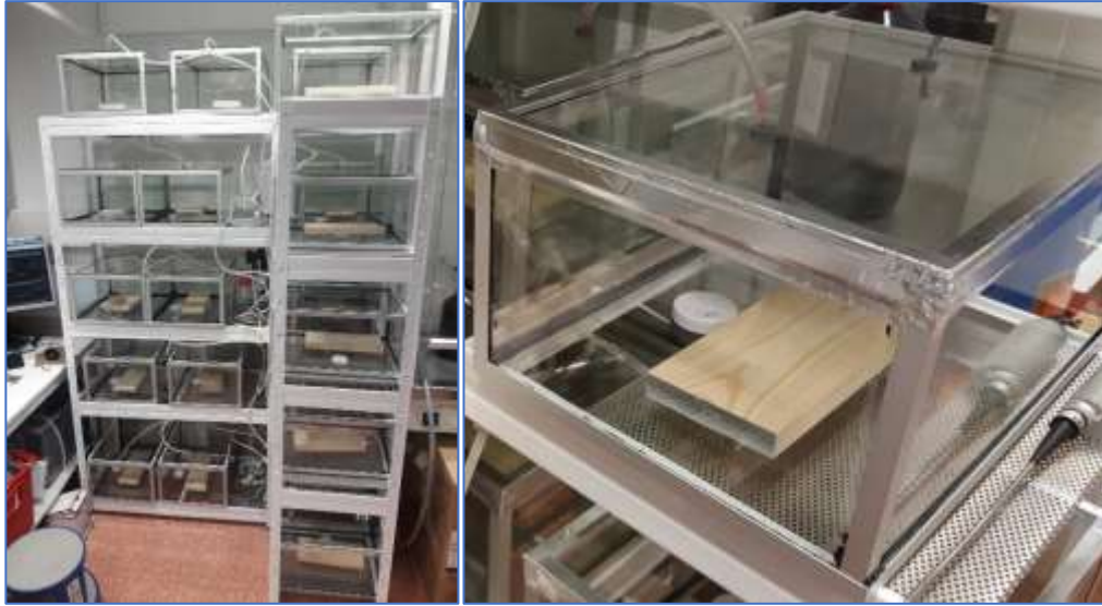
Kuva 2. Olosuhdekammiot (vasen kuva) ja sisällä oleva näyte (oikea kuva). Jokaiseen kammioon syötettiin vakioitu ilman tilavuusvirta 0,2 l/min. Kammion kansi tiivistettiin aina sulkemisen jälkeen alumiiniteipillä hallitsemattomien ilmavuotojen eliminointiseksi. Oikeanpuoleisessa kuvassa näkyy myös koekappaleen alumiiniteipillä suljettu pääty sekä valkoinen kiekko, joka on Bluetooth-yhteydellä toimiva Ruuvi Tag -kosteus- ja lämpötila-anturi. Vasen kuva: Henrik Heräjärvi, oikea kuva: Arttu Sivula.
